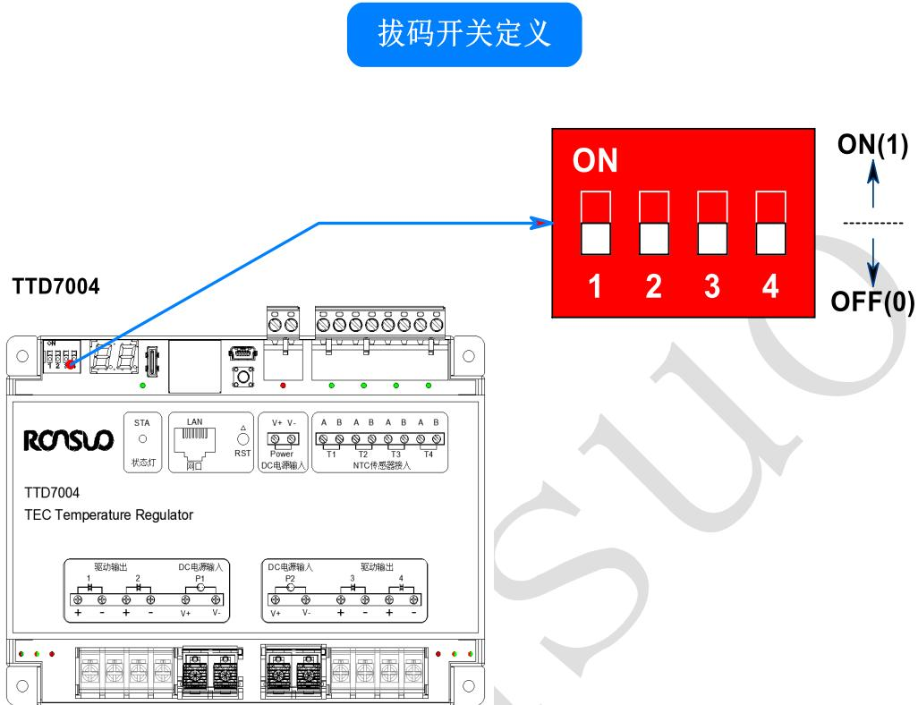
拔码开关定义 (设置拨码后需要重启设备生效):
