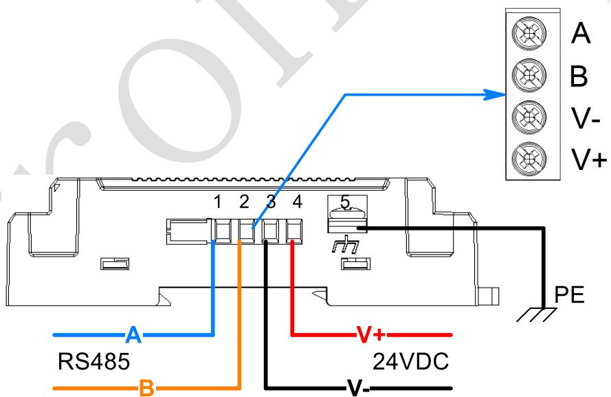
注: 1) 连接上行通讯和供电接入采集器时注意面板丝印标识正确连接。
