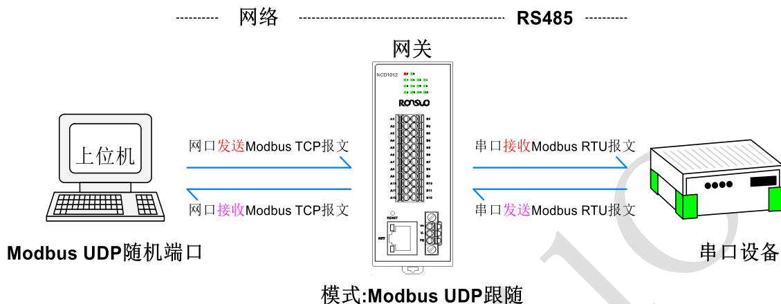
2、多端口-【Modbus UDP 跟随】方式连接设备（NCD1012）示例列表：
