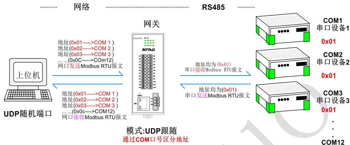
2、单端口网关-【UDP 跟随】方式连接设备 (NCD1012) 示例列表:
