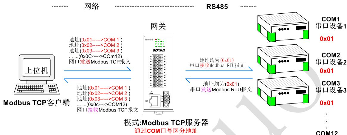
2、单端口网关-【Modbus TCP 服务器】方式连接设备（NCD1012）示例列表：
