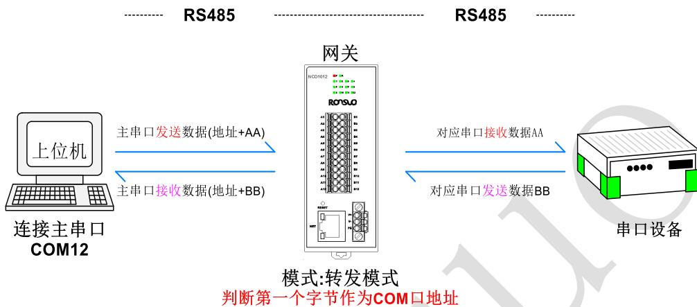
2、Modbus 串口转发-【转发模式】方式连接设备（NCD1012）示例列表：
