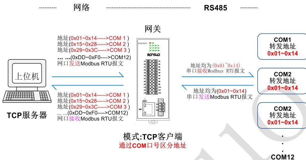
2、单端口网关-地址分段分发【TCP 客户端】方式连接设备（NCD1012）示例列表：
