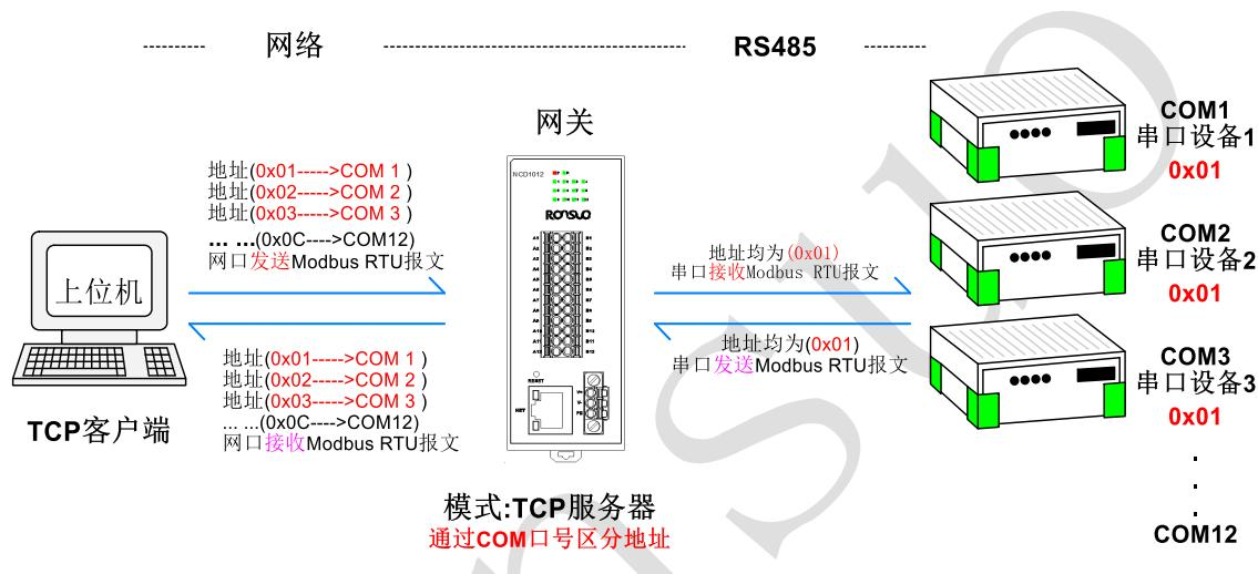
2、单端口网关-【TCP 服务器】方式连接设备 (NCD1012) 示例列表：
