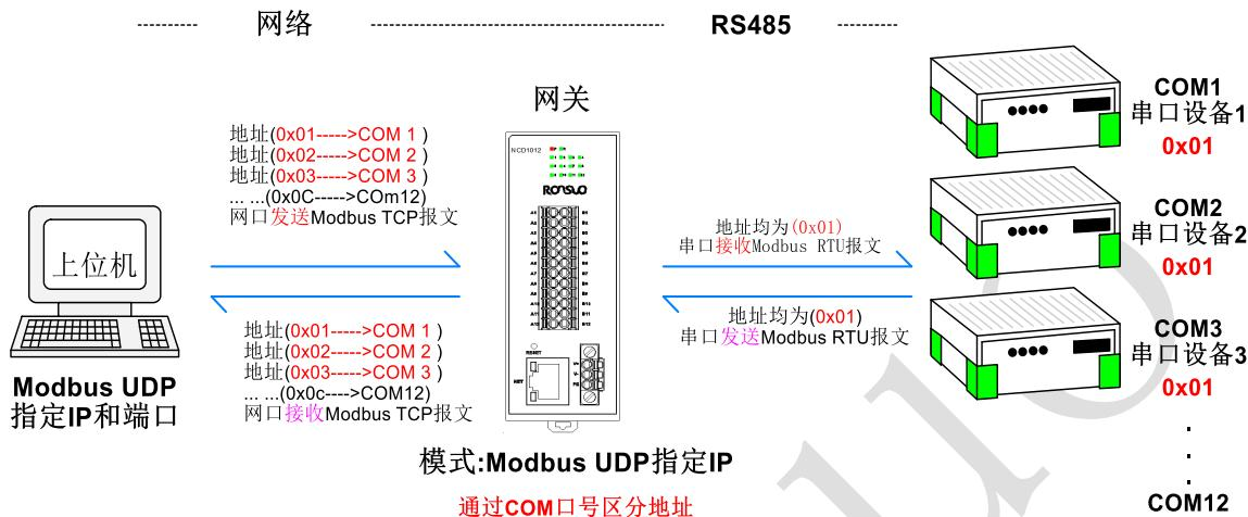
2、单端口网关-【Modbus UDP 指定 IP】方式连接设备 (NCD1012) 示例列表:
