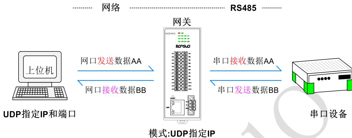
2、多端口-【UDP 指定 IP】方式连接设备（NCD1012）示例列表：
