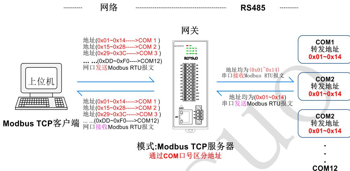
2、单端口网关-地址分段分发【Modbus TCP 服务器】方式连接设备（NCD1012）示例列表：
