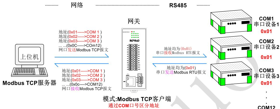
2、单端口网关-【Modbus TCP 客户端】方式连接设备（NCD1012）示例列表：
