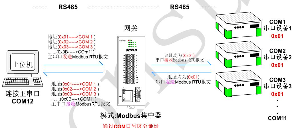
2、Modbus 串口转发-【Modbus 集中器】方式连接设备（NCD1012）示例列表：
