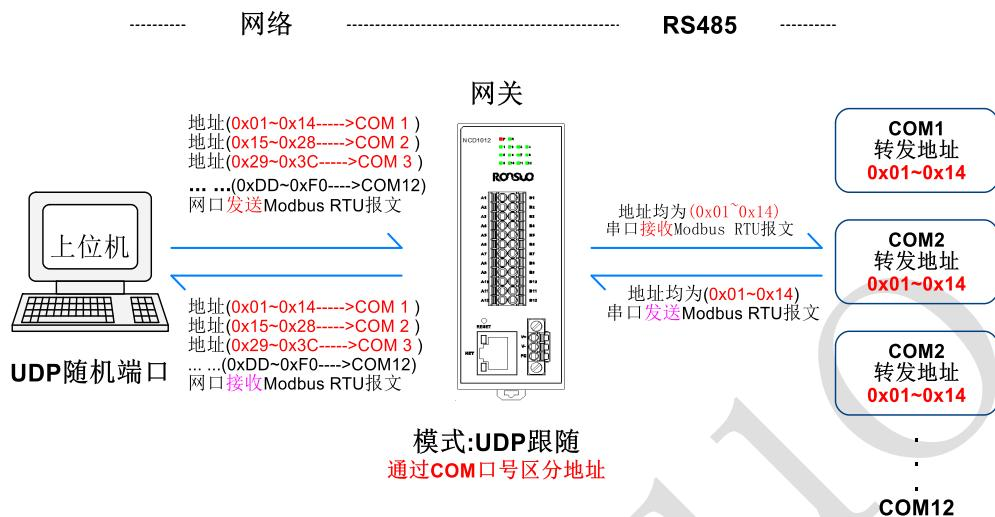
2、单端口网关-地址分段分发【UDP 跟随】方式连接设备（NCD1012）示例列表：
