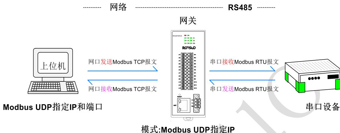
2、多端口-【Modbus UDP 指定 IP】方式连接设备（NCD1012）示例列表：
