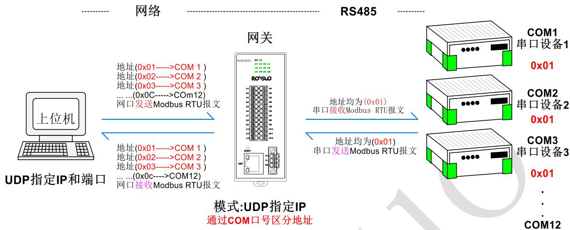
2、单端口网关-【UDP 指定 IP】方式连接设备 (NCD1012) 示例列表:
