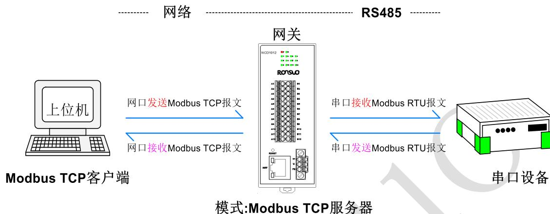
2、多端口-【Modbus TCP 服务器】方式连接设备（NCD1012）示例列表：
