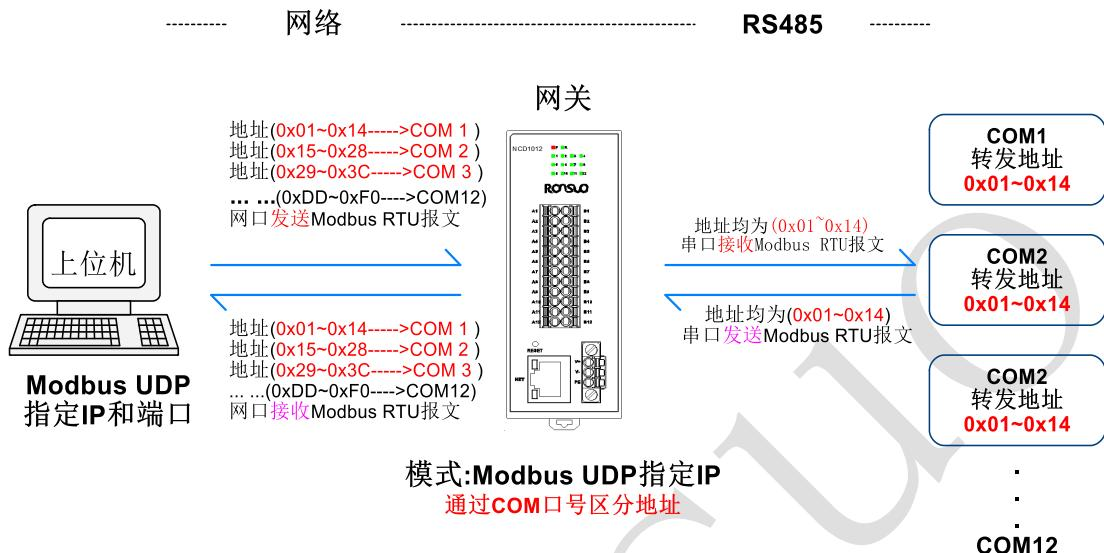
2、单端口网关-地址分段分发【Modbus UDP 指定 IP】方式连接设备（NCD1012）示例列表：
