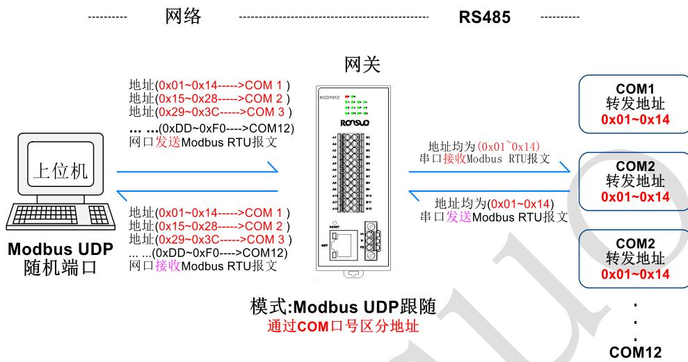
2、单端口网关-地址分段分发【Modbus UDP 跟随】方式连接设备（NCD1012）示例列表：
