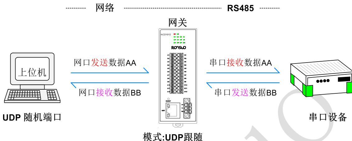
2、多端口-【UDP 跟随】方式连接设备（NCD1012）示例列表：
