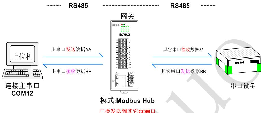
2、Modbus 串口转发-【Modbus Hub】方式连接设备（NCD10xx）示例列表：
