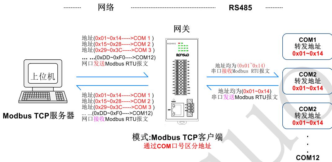
2、单端口网关-地址分段分发【Modbus TCP 客户端】方式连接设备（NCD1012）示例列表：
