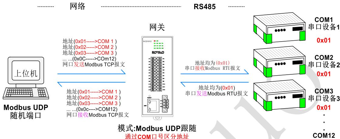
2、单端口网关-【Modbus UDP 跟随】方式连接设备（NCD1012）示例列表：
