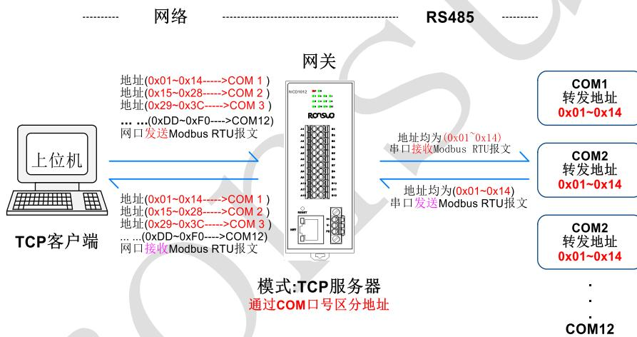
2、单端口网关-地址分段分发【TCP 服务器】方式连接设备（NCD1012）示例列表：
