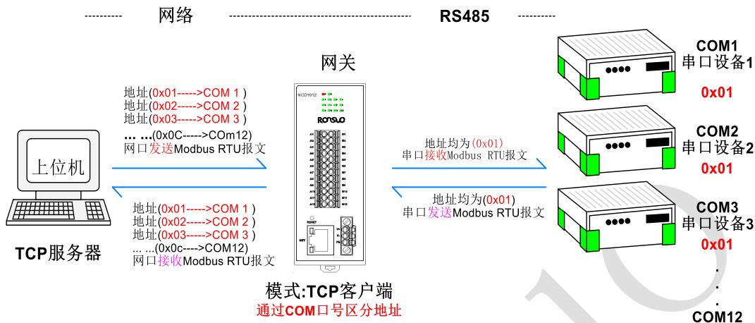
2、单端口网关-【TCP 客户端】方式连接设备 (NCD1012) 示例列表:
